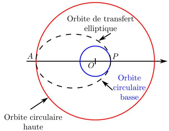
L'objectif de cette partie est de calculer les variations d'énergie mécanique que doit subir le satellite pour passer sur l'orbite de transfert, puis se stabiliser sur l'orbite circulaire haute.
