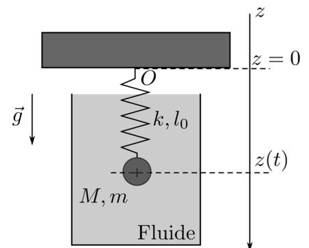
**Données :** On donne les valeurs suivantes. Rayon de la sphère  $a = 3,00 \text{ mm}$ . Longueur à vide du ressort  $l_0 = 5,0 \text{ cm}$ . Raideur du ressort  $k = 5,00 \text{ N} \cdot \text{m}^{-1}$ . Masse volumique de l'acier  $\rho = 7,80 \cdot 10^3 \text{ kg} \cdot \text{m}^{-3}$ .
