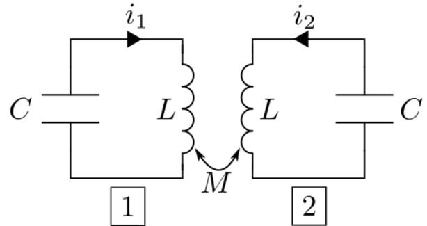
On considère que, initialement, le condensateur 1 est chargé avec une charge  $q_0$  sur l'armature du bas, et donc  $-q_0$  sur l'armature du haut. On ferme le circuit à  $t = 0$ , puis on étudie le comportement des charges des deux condensateurs,  $q_1(t)$  et  $q_2(t)$ . On admet que, lors du couplage par mutuelle de deux bobines  $L_1$  et  $L_2$ , la relation fondamentale est modifiée : elle s'écrit
