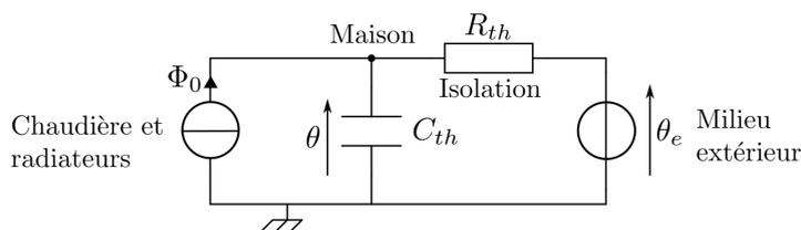
L'isolation des murs est représentée par une résistance thermique  $R_{th}$ , et la capacité de la maison à stocker l'énergie thermique par un condensateur de capacité  $C_{th}$ .
